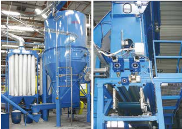
HDPE 플레이크 사일로 Silo for HDPE Flakes
