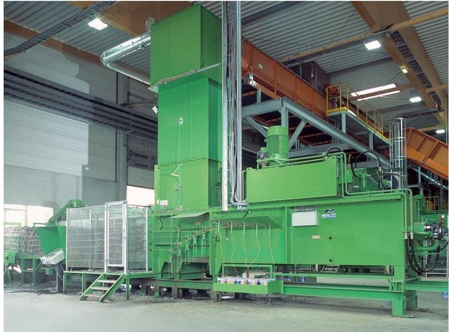
전 자동식 DOKON 압축기는 수평형 노끈결선방식이 적용된 강력하고, 효율적인 압축기입니다. 당사는 다년간의 경험과 연구개발을 통해 압축기 시장에서 가장 선호도가 높은 DOKON 압축기를 제작하였습니다. DOKON 압축기의 압축력은 820kN - 2000kN이며, 압축물 규격은 80 x 110 또는 110 x 110cm입니다. 강력한 압축력, 절단공정과 압축공정 분리, 그리고 개별 채널 조정이 가능한 특허받은 압축사전세팅기능 등의 완벽한 조합을 통해 고품질 압축물이 만들어집니다. 본 압축기는 극한 조건에서 연속 가동할 수 있게 개발되었습니다.
