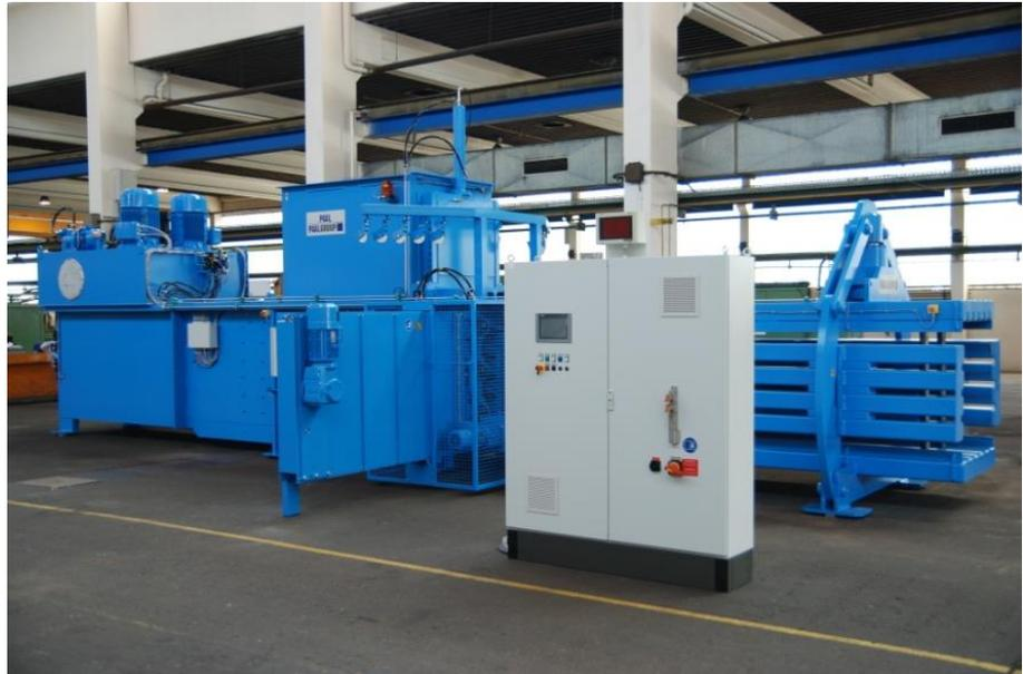
LIKON 전자동 채널압축기는 현장 가동을 통해 품질이 입증된 고급 모델이며, 최대 효율로 연속 가동되면서도 높은 처리용량을 보장합니다. 튼튼한 구조로 설계되었고, 압축력은 1200kN-1950kN 로서, 품질과 신뢰성이 입증된 모델이다. 강력한 압축력, 절단공정과 압축공정 분리, 그리고 개별 채널 조정이 가능하며, 압축도가 뛰어난 압축물을 만들어 냅니다. 정교한 기술 및 사용자 편의개선을 통해 LIKON 압축기를 다양한 폐기물에 적용할 수 있습니다. 특히 수평형 결속기능을 채용하여 부피가 작으면서 고중량인 물체에 매우 적합합니다. 신형 LIKON 압축기에 가격-효용 비율을 높이기 위한 연속가동 기준을 적용하여, 당사에서는 연속가동 시 높은 생산성을 보증합니다.
