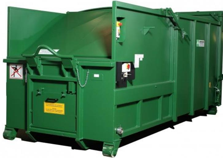
운반차량의 종류에 따라, 이동식 폐기물컴팩터는 롤오프 트럭 또는 리프트 트럭에 사용할 수 있습니다. 롤-온/롤-오프 트럭용 AVERMANN 이동식 폐기물압축기는 전세계 고객들로부터 신뢰할 만한 압축기로 평가받고 있습니다. 본 이동식 폐기물컴팩터는 유연성이 뛰어나며, 경사진 높은 측벽, 개별 개방 체계, 4 점 잠금장치 등을 부착할 수 있다. 당사는 컴팩터에 램프(Ramp)를 부착하는 것은 물론, 전면이나 측면 투입 방식으로 제작할 수 있습니다. 전기제어장치가 기본사양으로 장착됩니다.
