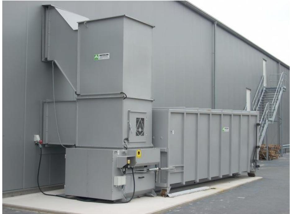
컴팩터는 생활 및 산업 폐기물을 압축함으로써 한정된 매립시설/공간을 효율적으로 이용 가능하게 합니다. 또한, 전용 밀폐 보관함에 폐기물을 적재하여 폐기물의 비산, 악취 및 오염수 유출을 원천 차단함으로써 환경오염을 방지합니다. AVERMANN 의 고정식 스크류 컴팩터는 강력한 기어모터 및 최적의 체인드라이브 시스템으로 업계 최고의 압축률을 실현하였으며, 전(全)자동화 시스템(광센서 감지 시스템)으로 사용자 편의성을 높인 유럽 최고의 컴팩터입니다. 강화되는 환경규제/값비싼 폐기물 처리비용, 이제 더 이상 걱정하지 마세요. AVERMANN 고정식 스크류 컴팩터로 모두 해결하실 수 있습니다.
