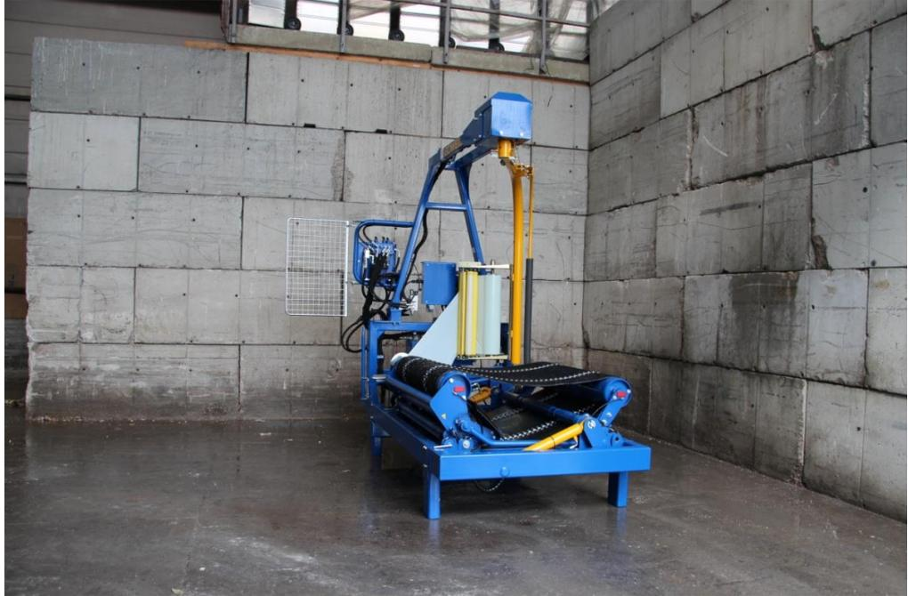
G4010 Q Industry와 마찬가지로 G3010 Q Industry 역시 사각형 및 원통형 베일을 포장할 수 있는 장비입니다. 최대 1.60m 길이의 싱글 베일까지 포장 가능하며, 포장 완료 된 베일을 좌/우 어 디든지 하륙할 수 있는 기능을 갖추고 있습니다. 주문사양에 따라 맞춤 제작이 가능한 G3010 Q Industry는 다양한 현장에서, 다양한 고객을 만족시킬 수 있는 최고의 포장 기기입니다
