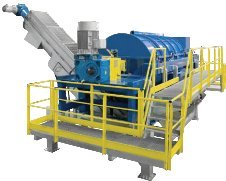
Prelavaggio a freddo ad alta frizione High friction cold prewashing
