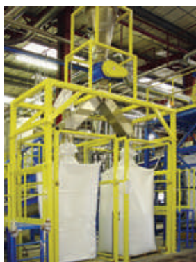
Stazione riempimento big-bag Big-bag filling station
