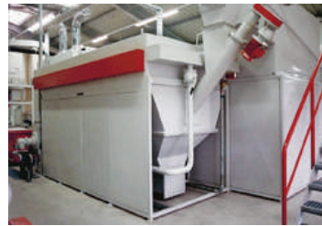
Vasca di decantazione Decantation trough
